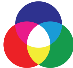
▲ Abb. 4.1 Das RGB-Farbschema : Rot (0-255) Grün (0-255) Blau (0-255) Mit diesem Farbschema arbeitet jeder Monitor. Kein Farbanteil: Schwarz
