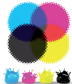
▲ Abb. 4.2 Das CMYK-Farbschema : Cyan (0-100%) Magenta (0-100%) Yellow (0-100%) Key (0-100%) Mit diesem Farbschema druckt man auf weißes Papier. Kein Farbanteil: Weiß
